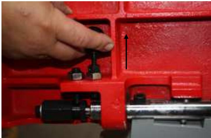
Ouvrir les tables de la dégauchisseuse et les verrouiller.
