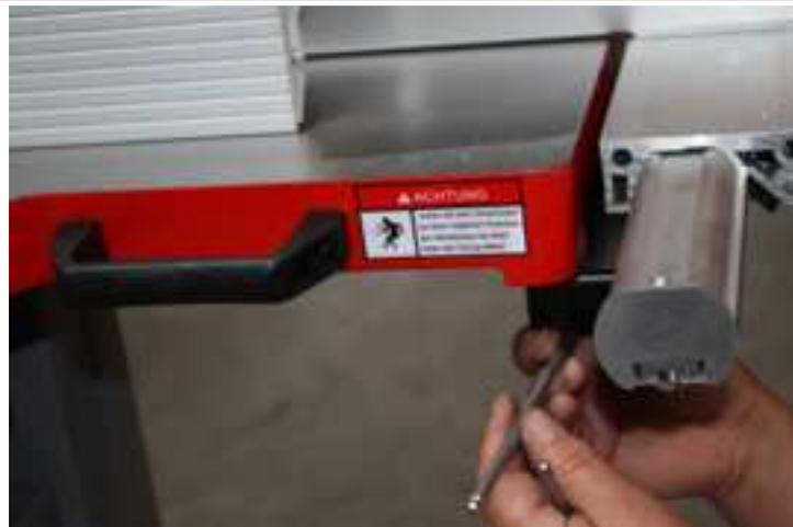
Le guide doit être aligné avec la table.
