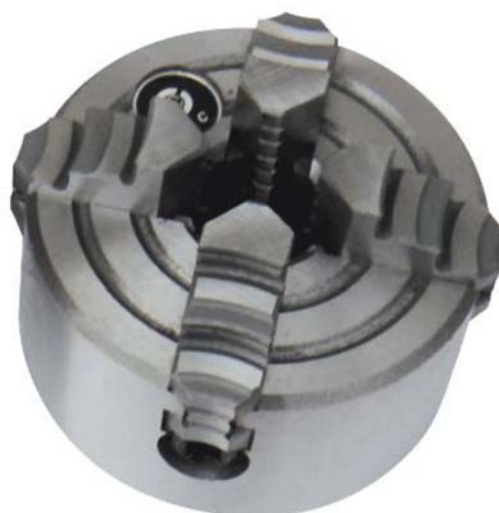
Figure 8-6 : Mandrin à quatre mors indépendants
