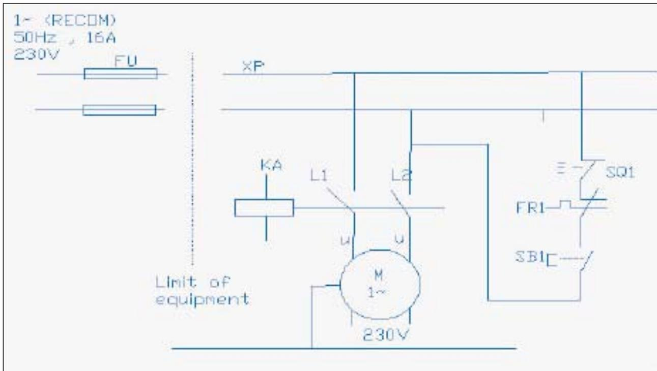
Das Elektroschema, enthält die notwendigen Angaben für den korrekten Anschluß Ihrer Maschine ans Netz. Kontrollieren Sie, dass der Motor in die richtige Richtung läuft (im Gegenuhrzeigersinn, wenn die Antriebswelle betrachtet wird). Ist dies nicht der Fall, muß die Maschine abgestellt und die PROMAC-Serviceestelle kontaktiert werden. Die Maschine wird mit einem 230 Volt Netzstecker geliefert. Änderungen des Anschlusses muß von einem Fachmann erstellt werden.
